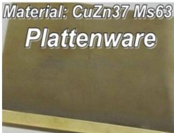
MS - Platten: 200 x 200mm im Sägezuschnitt -0/+2mm
