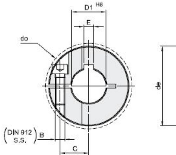
Werkstoff: rostfreier Stahl 1.4301, Nut nach DIN
